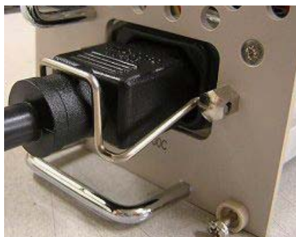
【図12】電源ケーブルの固定方法 (この写真は類似製品での例です)
